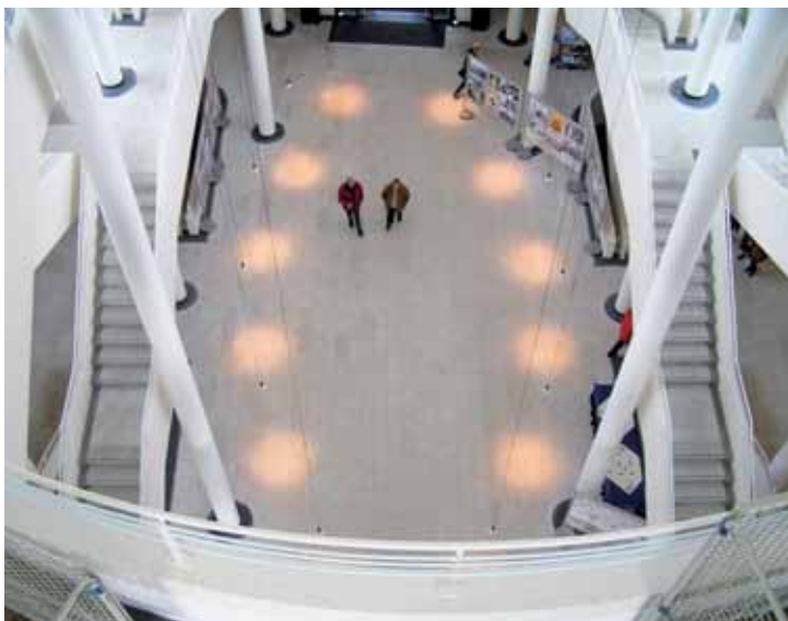
Verlichting van de centrale hal van het stadhuis Apeldoorn door twaalf CDM-i PAR38 spots.
